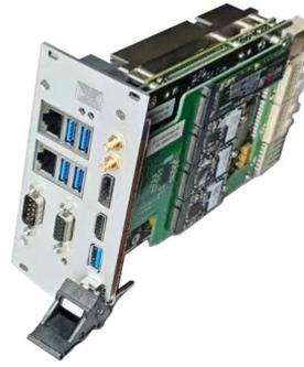
**RX39500** 设计为 3U，三宽 CompactPCIe/PXIe 模块，采用被动对流散热模式。
